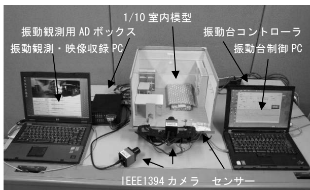
写真6 小型振動台による室内模型の加振と映像・波形収録の状況
